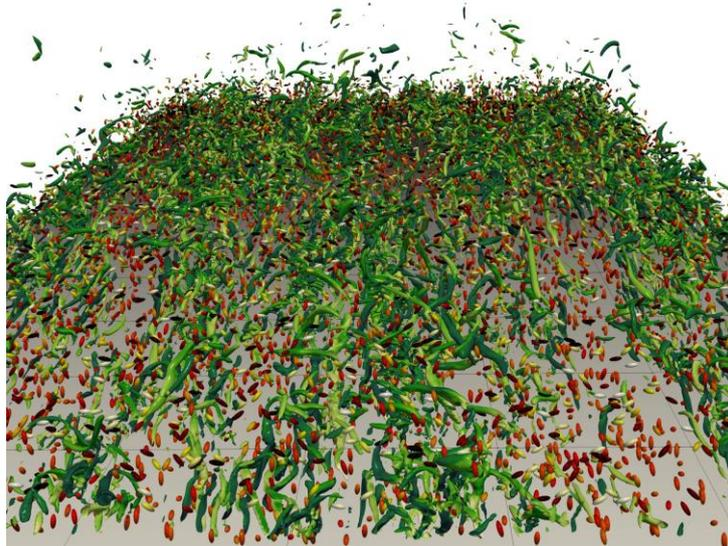
*Figure.* Simulation DNS présentant l'interaction entre des structures cohérentes (en vert) et des ellipsoïdes de révolution (la couleur dépend de l'orientation) au sein d'un écoulement turbulent de canal. Le nombre de Reynolds de l'écoulement est  $Re_\tau = 1000$  et le rapport d'aspect des ellipsoïdes est égal à 3.
